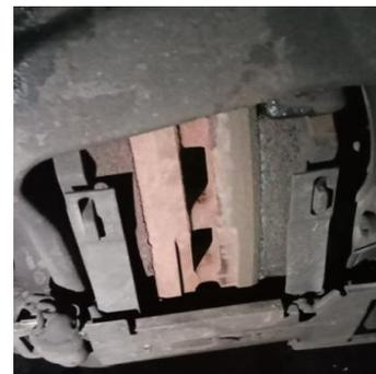
第2台车：同样配置，同样路况，驾驶员正常使用液缓，行驶66224公摩擦片磨损正常，摩擦片厚度还剩一半以上。
