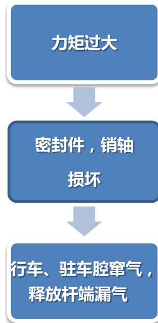
**注意：在行车状态，解除驻车时拧释放螺杆，禁止用风枪打紧。**
