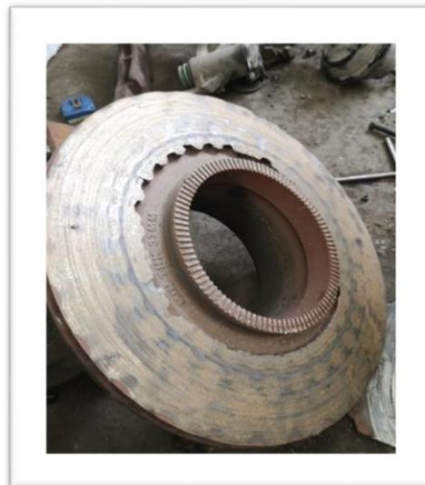
淋水装置造成气压不够，导致摩擦片和盘异常磨损
